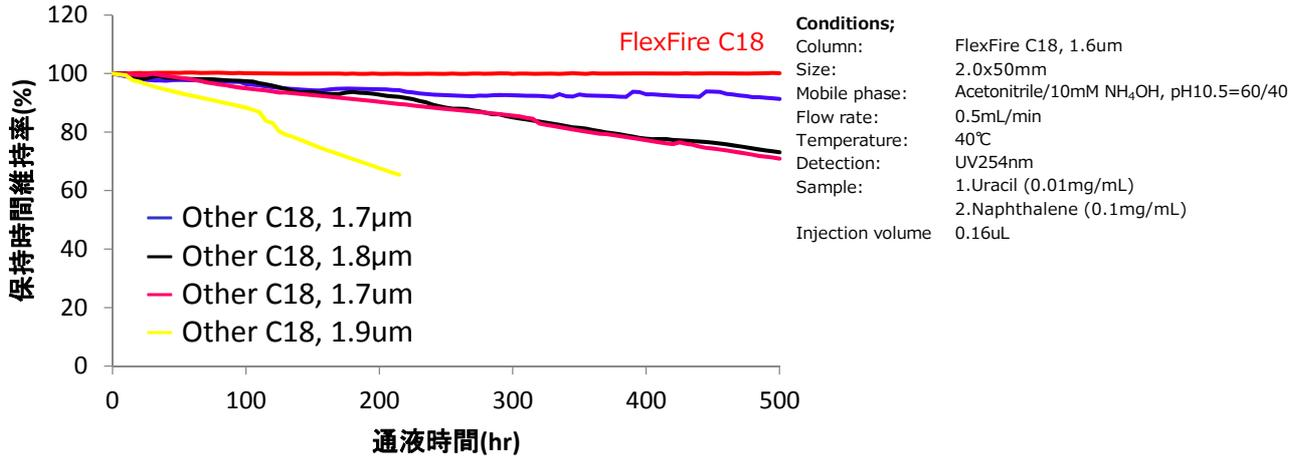
シリカゲル基材を使用した充填カラムは、酸性条件下で加水分解による結合の切断が起こり、アルカリ条件下ではシリカゲルの溶解が起こります。
