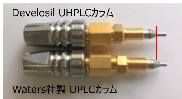
僅かな長さの違いが結果と見た目に大きな影響を与える
